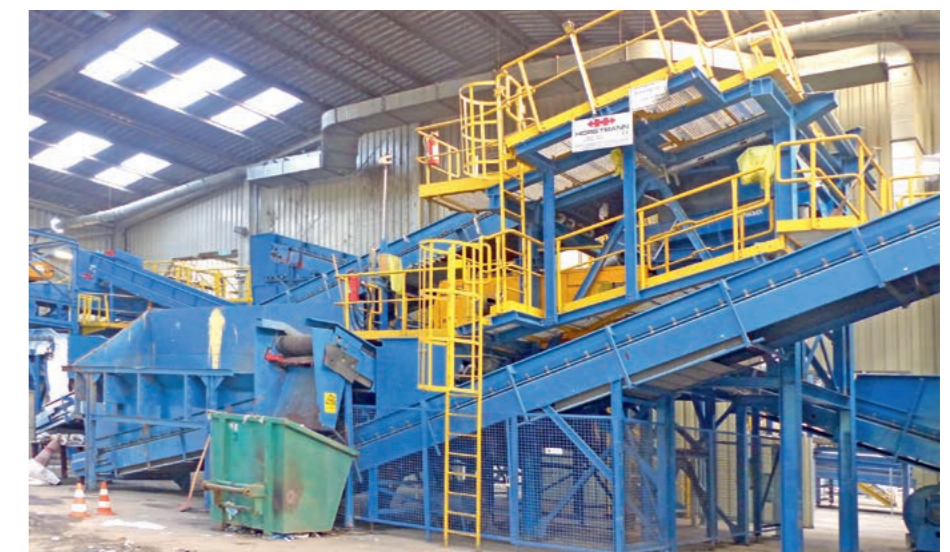
Kunststoffreste, Textilien, verunreinigte Pappen und dergleichen werden im EZS Sachsenhagen mechanisch aussortiert und zu Ersatzbrennstoffen verarbeitet.
