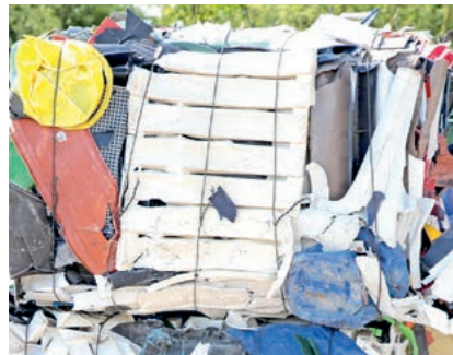
Die aussortierten Hartplastik-Abfälle werden zu Ballen gepresst, ehe sie zu unterschiedlichen Recycling-Unternehmen transportiert und dort weiterverwertet werden.
