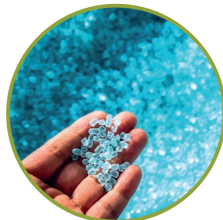
Aus den recycelten Kunststoffabfällen entstehen zunächst solche Regranulat-körner, die anschließend bei der Neuproduktion von Kunststoffgegenständen wiedereingesetzt werden.
